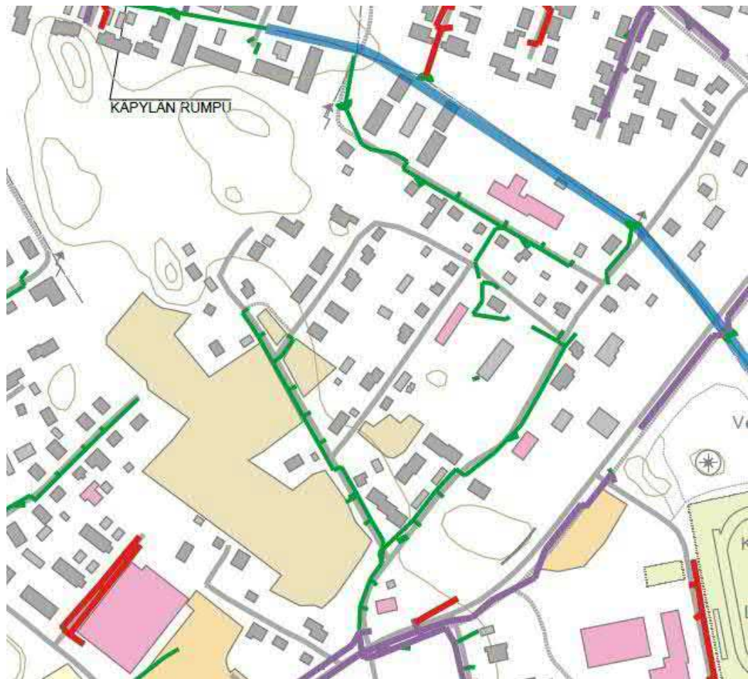
Kuva 17. Kruunuhaan alueen rakennetut hulevesiviemärit. Sweco ympäristö Oy 2016.
