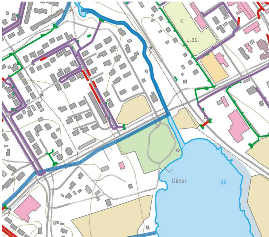
Kuva 11. Tapalan alueen rakennetut hulevesiviemärit. Sweco ympäristö Oy 2016.
